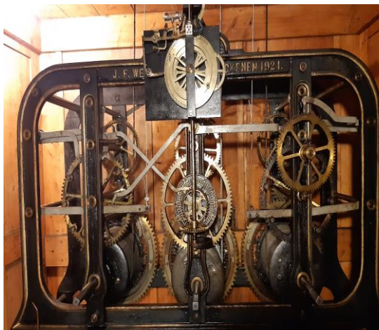
Blick auf die mechanische Turmuhr Links: Viertelstundenschlag Mitte: Zeigerwerk Rechts: Stundenschlag
